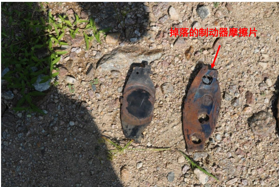
图 9 事故车辆左前轮制动器内侧掉落的摩擦片
